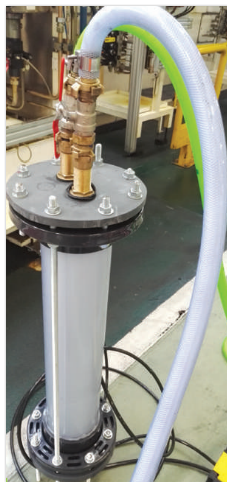
Mousseur : de l'eau additionné de tensio-actif ainsi que de l'air sous pression sont injectés simultanément pour former la mousse de blocage.
