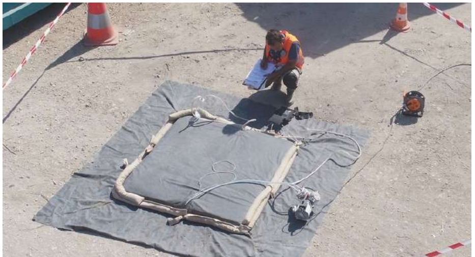
Fig. 5 : Mesures par chambre à flux des débits de biogaz
