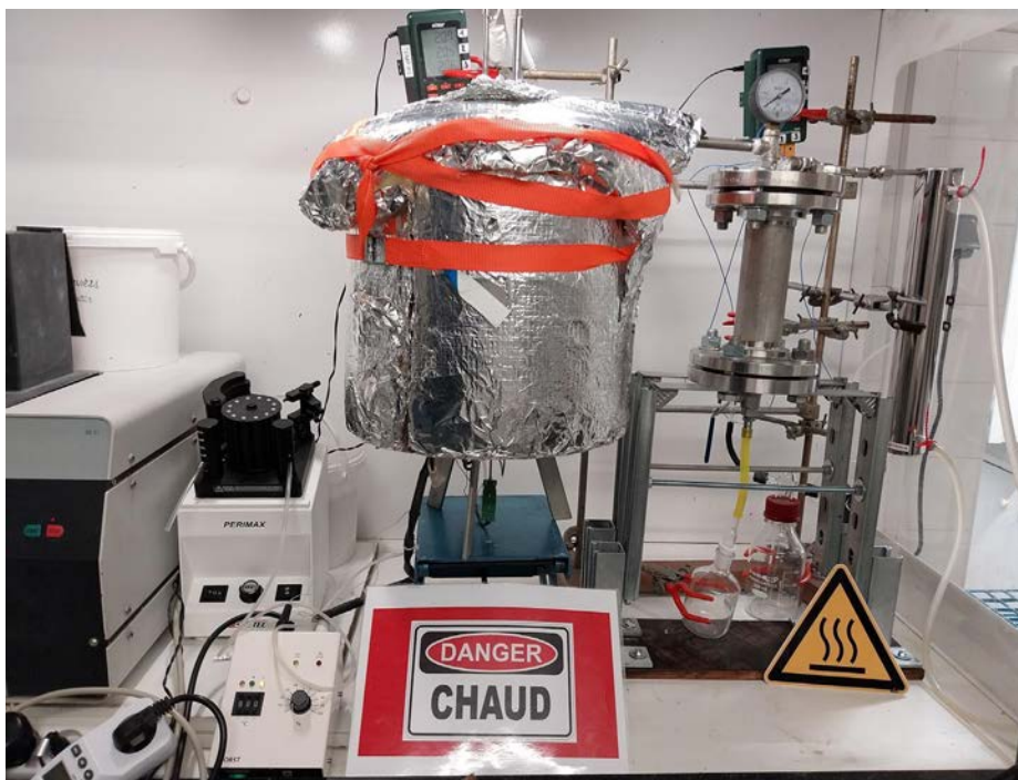
Illustration n°2 : montage de l'essai de désorption thermique en laboratoire
