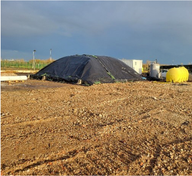
Biopile thermorégulée pilote et son unité de traitement en cours d'exploitation
