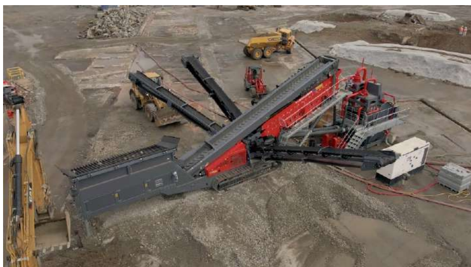
Unité de lavage
