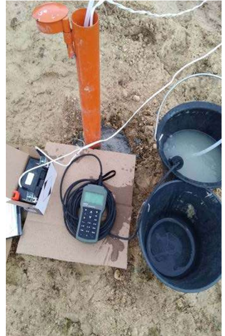
Figure 2 - Prélèvement d'eaux souterraines
