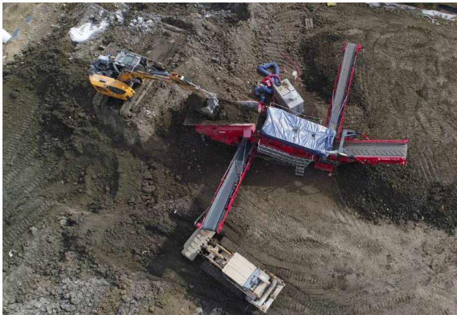
Vue aérienne du traitement par criblage capoté
