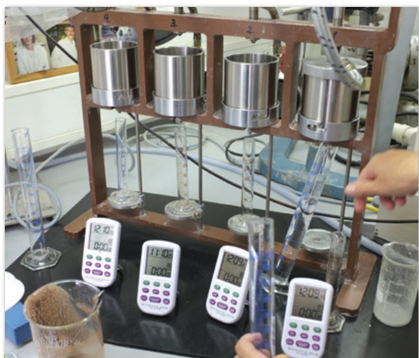
Essais en laboratoire sur cellules baroides : détermination de la dynamique de dessiccation de boues à pression constante.
