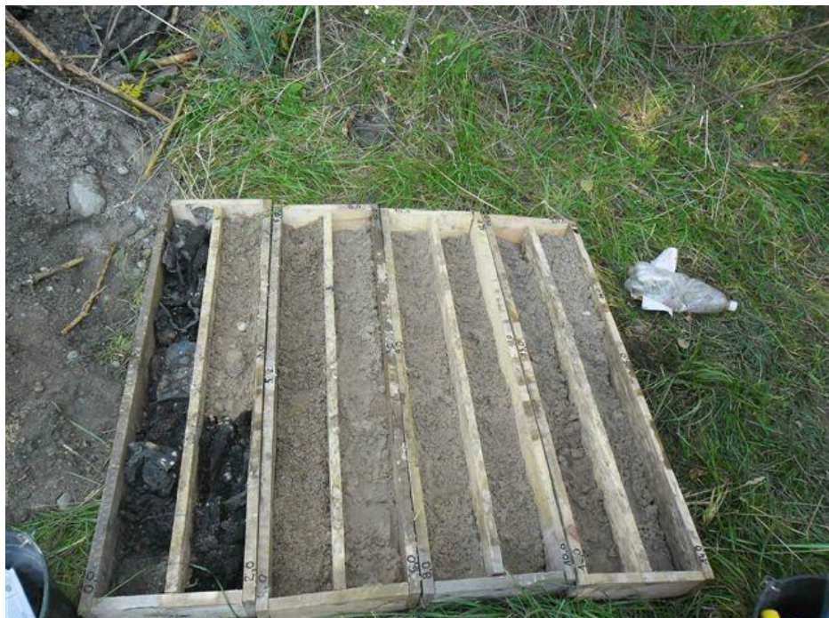
Figure 3 - Carottes de sol : présence visuelle de pollution entre 0 et 2,5 m de profondeur
