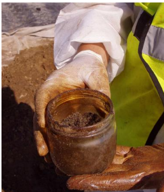
Figure 4 - Teinte caractéristique du gant au contact d'une pollution concentrée en HAP
