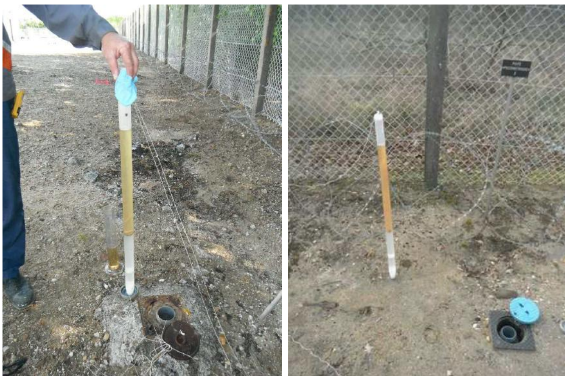
Figure 10 - Prélèvement d'eau avec présence de phase organique flottante
