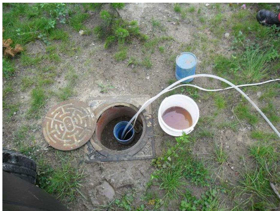
Figure 6 - Présence de phase organique coulante lors d'un prélèvement d'eau souterraine dans un piézomètre profond (préalablement identifiée avec une sonde multiphases)
