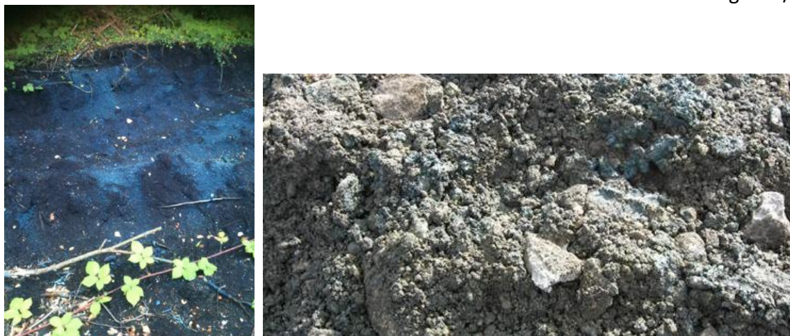
Figure 11 - Pollutions par des ferro-cyanures (couleur caractéristique bleu à bleu-gris)
